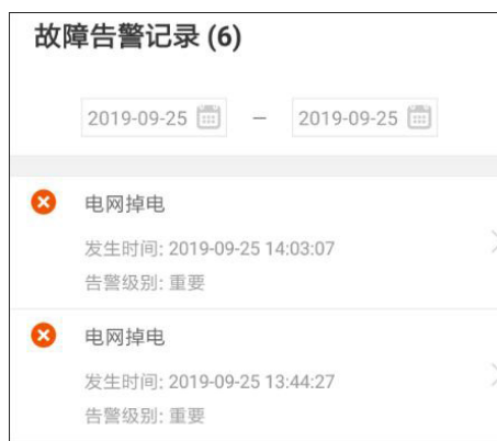
图 7-7 故障告警记录
