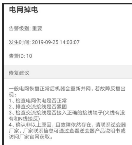
图 7-8 故障告警记录
